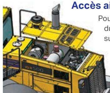
Pour les inspections du moteur, la partie supérieure du capot peut être enlevée en quelques minutes, afin de faciliter l'accès au compartiment moteur.
