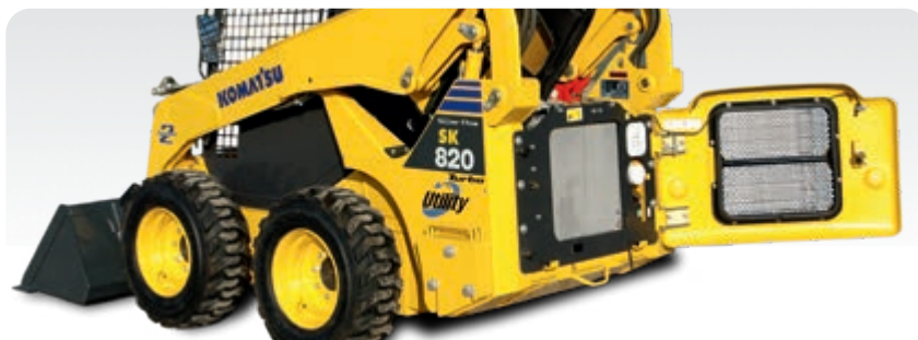
A escotilha traseira: inspeção simples e limpeza dos radiadores
