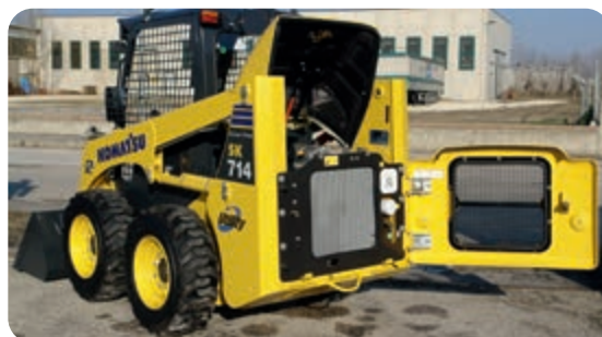
A escotilha traseira: inspeção simples e limpeza dos radiadores
