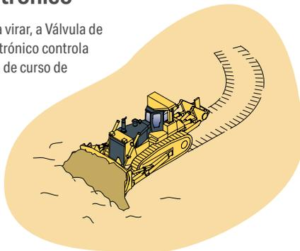
Durante o nivelamento em descidas, a Válvula de Modulação com Controlo Electrónico controla automaticamente as embraiagens e os travões da direção em função da inclinação da máquina ou do grau de carga, reduzindo a contra-direção e produzindo uma operação de nivelamento suave.
