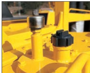
O depósito de combustível está equipado com um respirador de elevada filtração com válvula de pressão para evitar a entrada de pó.
